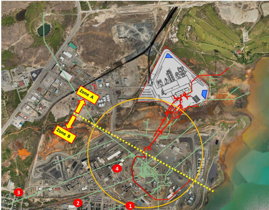
Figure 2 : Vue en plan des installations de surface, incluant une projection des galeries de développement L322, et l'identification des secteurs de dynamitage (Zone A), de réhabilitation (Zone B), et des récepteurs sensibles considérés (#1 à #4)
